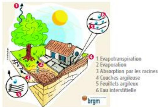
Un sol argileux change de volume selon son humidité comme le fait une éponge ; il gonfle avec l'humidité et se resserre avec la sécheresse, entraînant des tassements verticaux et horizontaux, des fissurations du sol.
